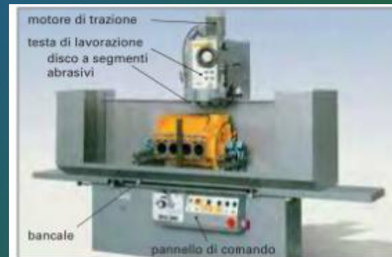
Figura 5: Macchina rettificatrice-fresatrice per blocchi e testate motore
