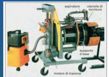
Figura 4: Apparecchio di tornitura per guarnizioni di ceppi freno
